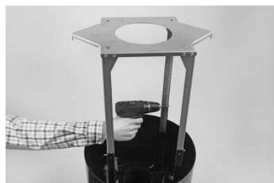
Im Falle einer Installation im Ablufbetrieb ist vorab der Abluftschlauch mit einem Ende an der Abluftöffnung des Motors zu befestigen und das obere Kaminteil über die Schienen zu stecken.
