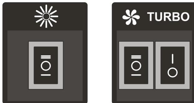
Die Steuerung erfolgt über die rechts hinter der Frontblende befindlichen Kippschalter (s. Abb. Steuerung), welche nur bei geöffnetem Auszug erreichbar sind. Es ist zu beachten, dass die Haube eine interne Abschaltung hat, die die Haube komplett abschaltet sobald der Auszug geschlossen wird. Bei Öffnung schaltet sich die Haube gemäß den vorigen Einstellungen wieder ein (gilt auch für Licht).
