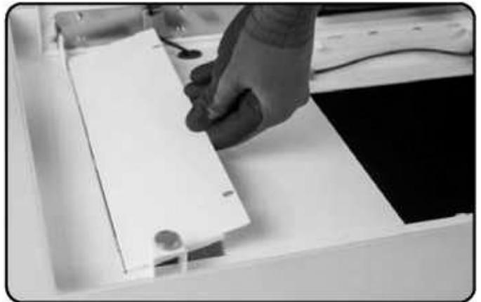
Öffnen Sie die Frontklappe der Dunstabzugshaube und entnehmen Sie den/die Fettfilter. Schrauben Sie die Montageverkleidungen auf beiden Seiten der Ansaugöffnung ab und entnehmen diese.
