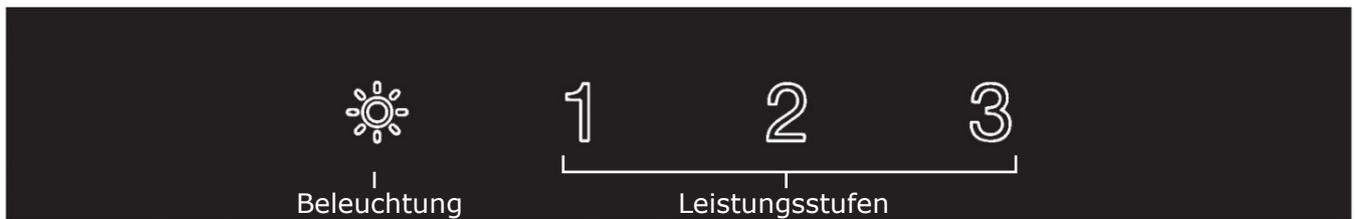
Die Steuerung erfolgt über eine 3-Stufige Sensorsteuerung an der Unterseite der Dunstabzugshaube. 1, 2 und 3 schalten den Motor in der entsprechenden Leistungsstufe ein. Erneutes Berühren der eingestellten Leistungsstufe schaltet den Motor wieder aus.
